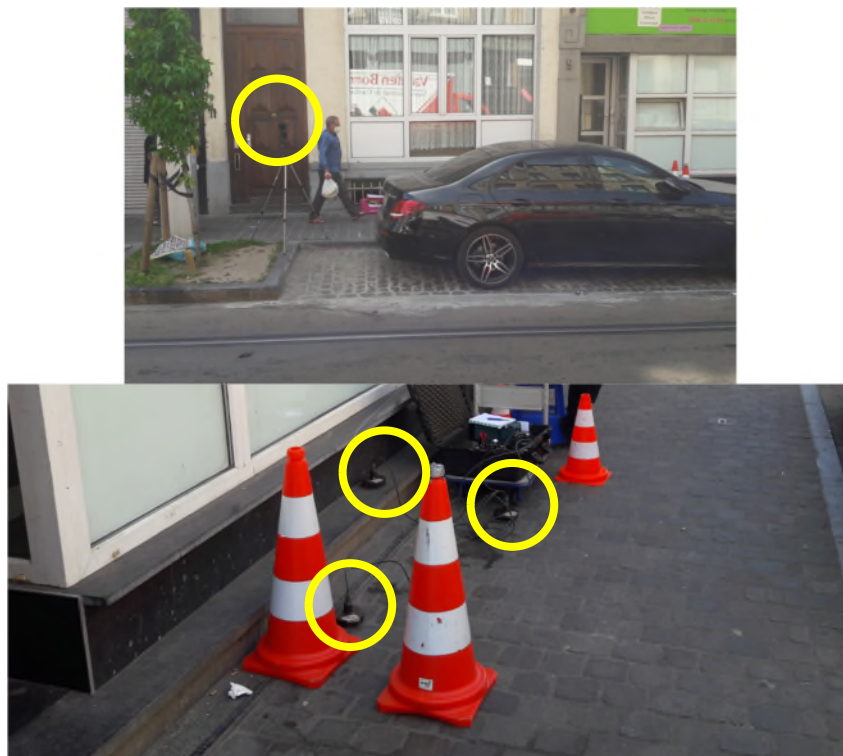
Figuur 225: Positionering van de sensoren in de Van Ooststraat nr. 9-11 (Tractebel, juni 2020)
