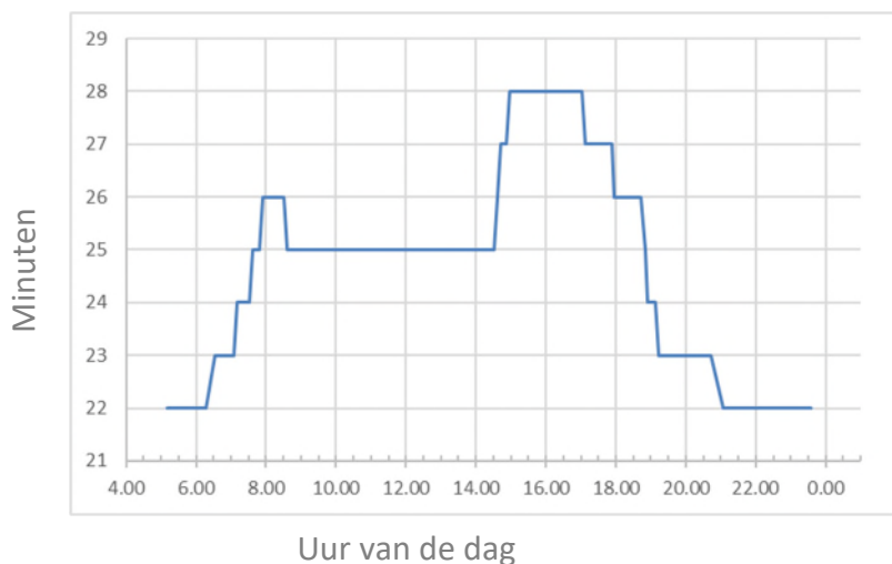
Figuur 39: Theoretische rittijd volgens het uur van de dag Rogier - Da Vinci (MIVB, 2019)
