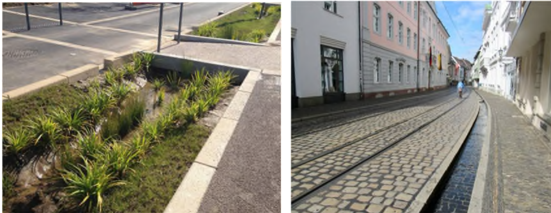
Figuur 258: Voorbeeld van een wadi (Ecowijk Raquet) en van een gootsteen (Fribourg) in een stedelijke omgeving
