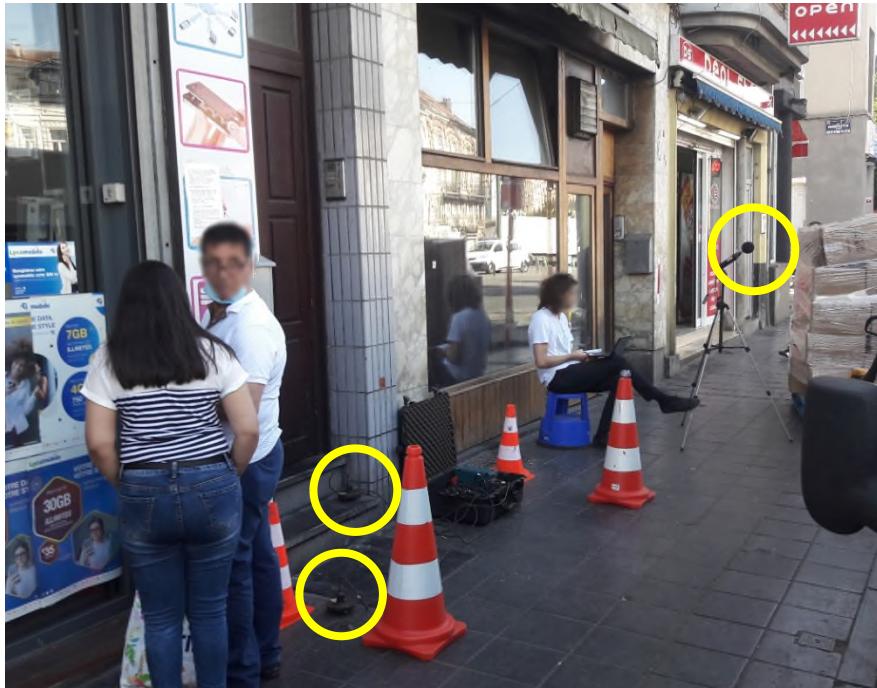
Figuur 221: Positionering van de geluidsmeters en sensoren op het Liedtsplein nr. 2-4 (Tractebel, juni 2020). De geluidsmeter ligt op een hoogte en de sensoren worden verticaal met de bodem geplaatst.
