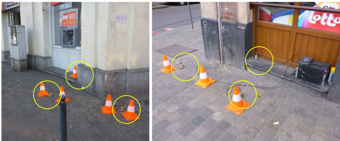
Figuur 209: Positie van de sensoren op S1 en S2 (D2S, 2018)
