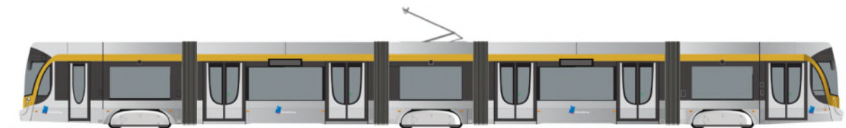
Figuur 20: Buitenprofiel van een T3000 tram (MIVB, n.d.)
