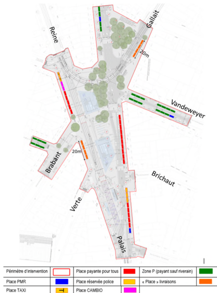
Figuur 148: Parkeertype binnen de interventieperimeter in de beoogde situatie (ARIES, 2020 op basis van BMN, 2018)
