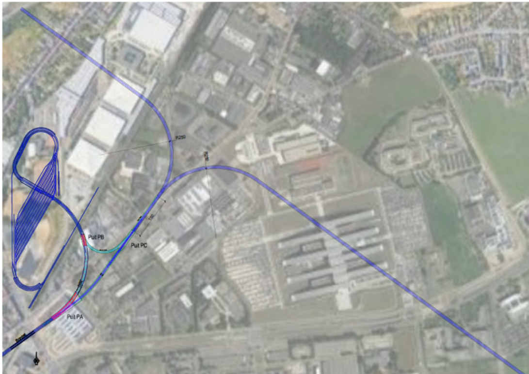
Figuur 167: Indicatief schema van de toegangskegel van de tunnelboormachine vanuit een verlengingskunstwerk onder de Décathlon (BMN, 2021)
