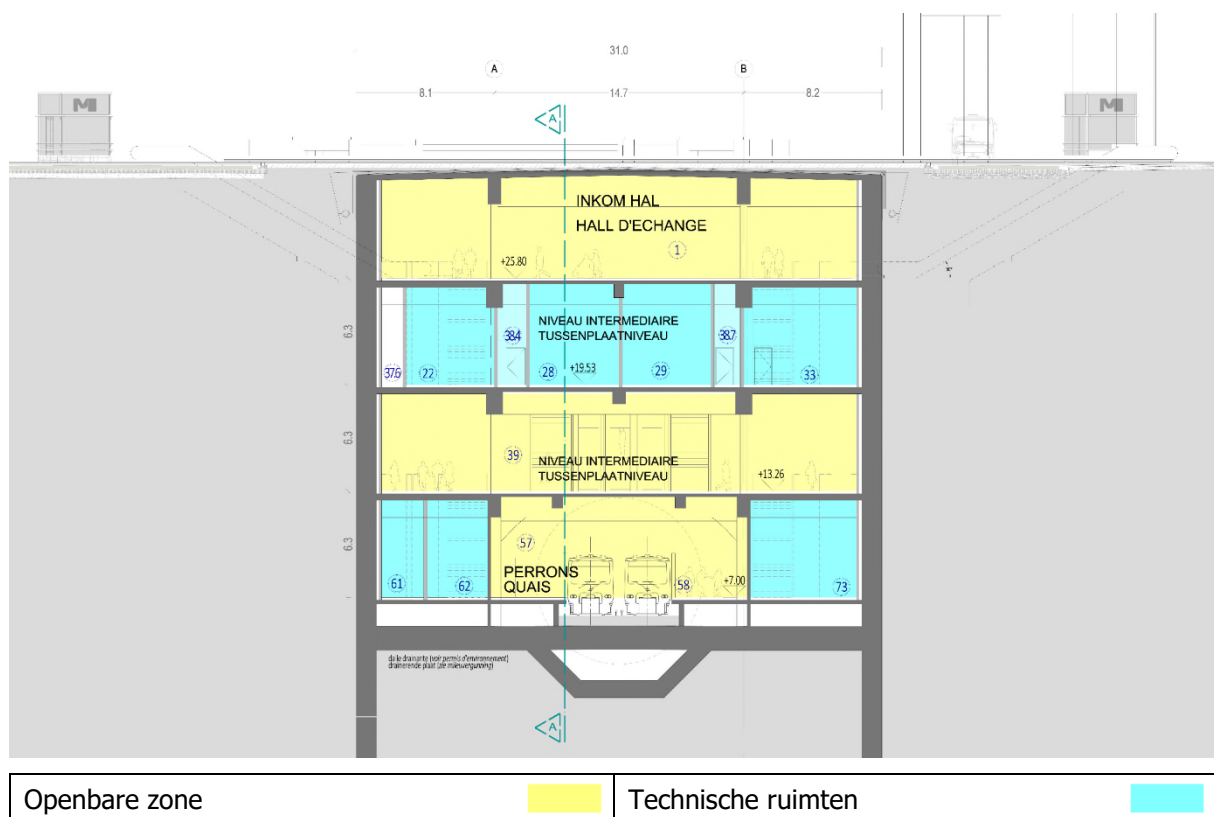
Figuur 76: Station Colignon, dwarsdoorsnede (BMN, 2018)
