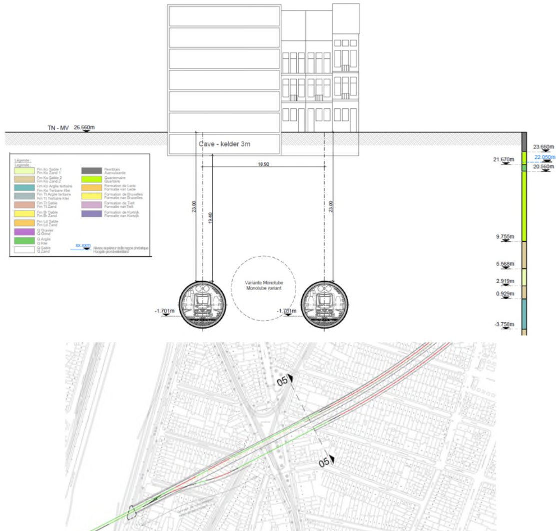
Figuur 185: Vergelijking van de positie van de tunnels (een buis en twee kokers) aan de Vandeweyerstraat in Schaarbeek (BMN, 2020)
