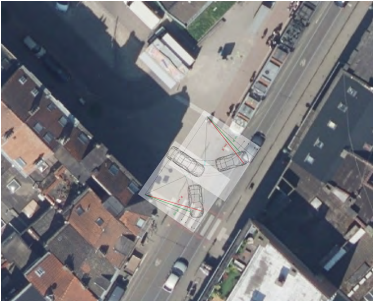
Figuur 228: Uitrijmanoeuvres van de plaatselijke tijdelijke weg tijdens de werkzaamheden op de Helmetsesteenweg (ARIES, 2021)
