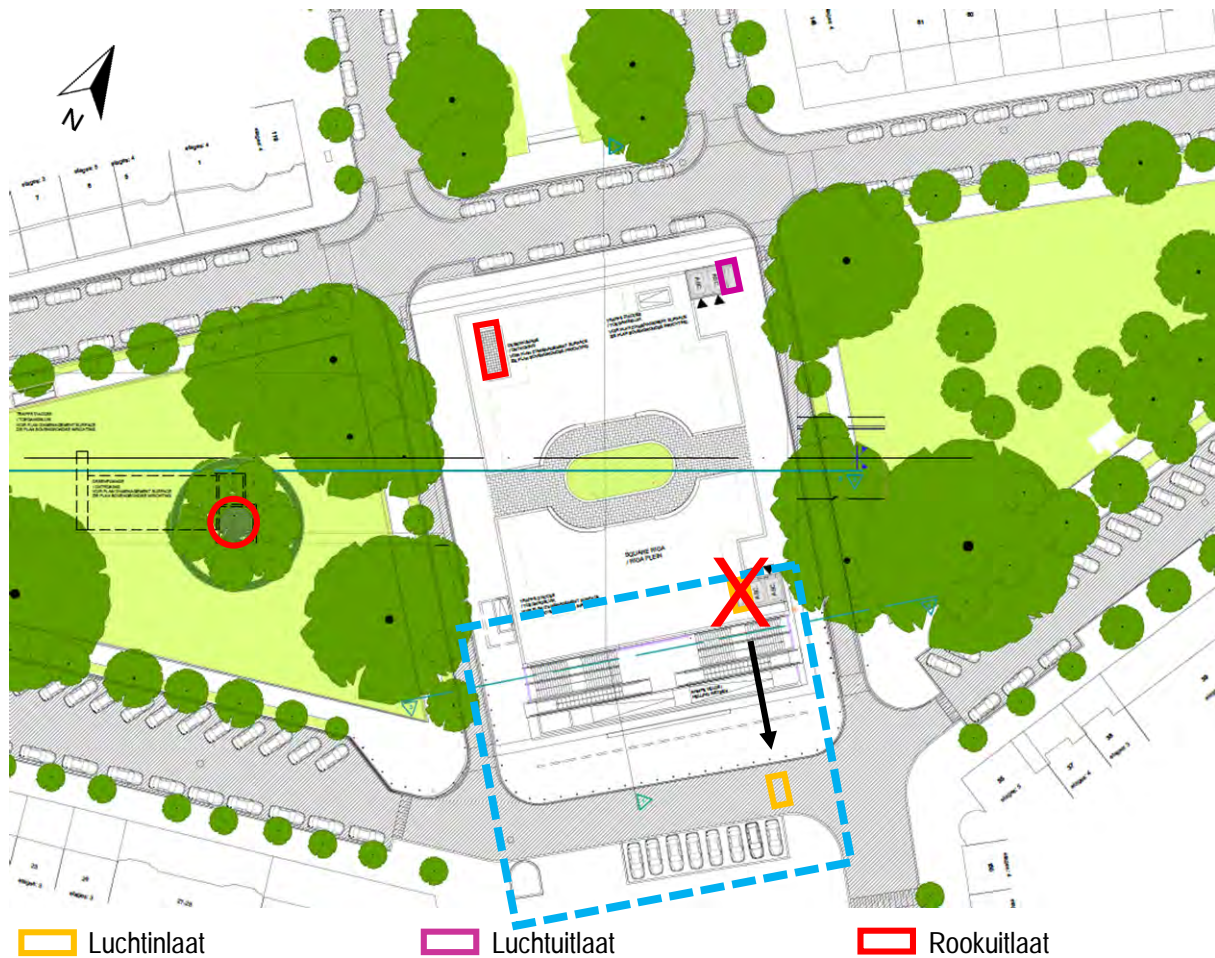
Figuur 198: Luchtinlaat te verplaatsen op de alternatieve locatie - Station Riga (ARIES, 2020 op BMN-achtergrond, 2018)
