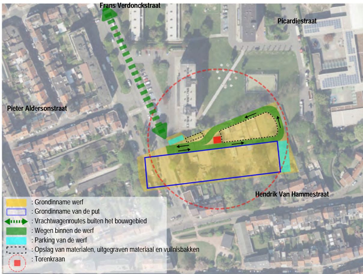
Figuur 180: Optie A - Toegangs- en vrachtwagenroute via de Verdonckstraat en door de geplande nieuwe gemeentelijke ontwikkeling (ARIES, 2020)
