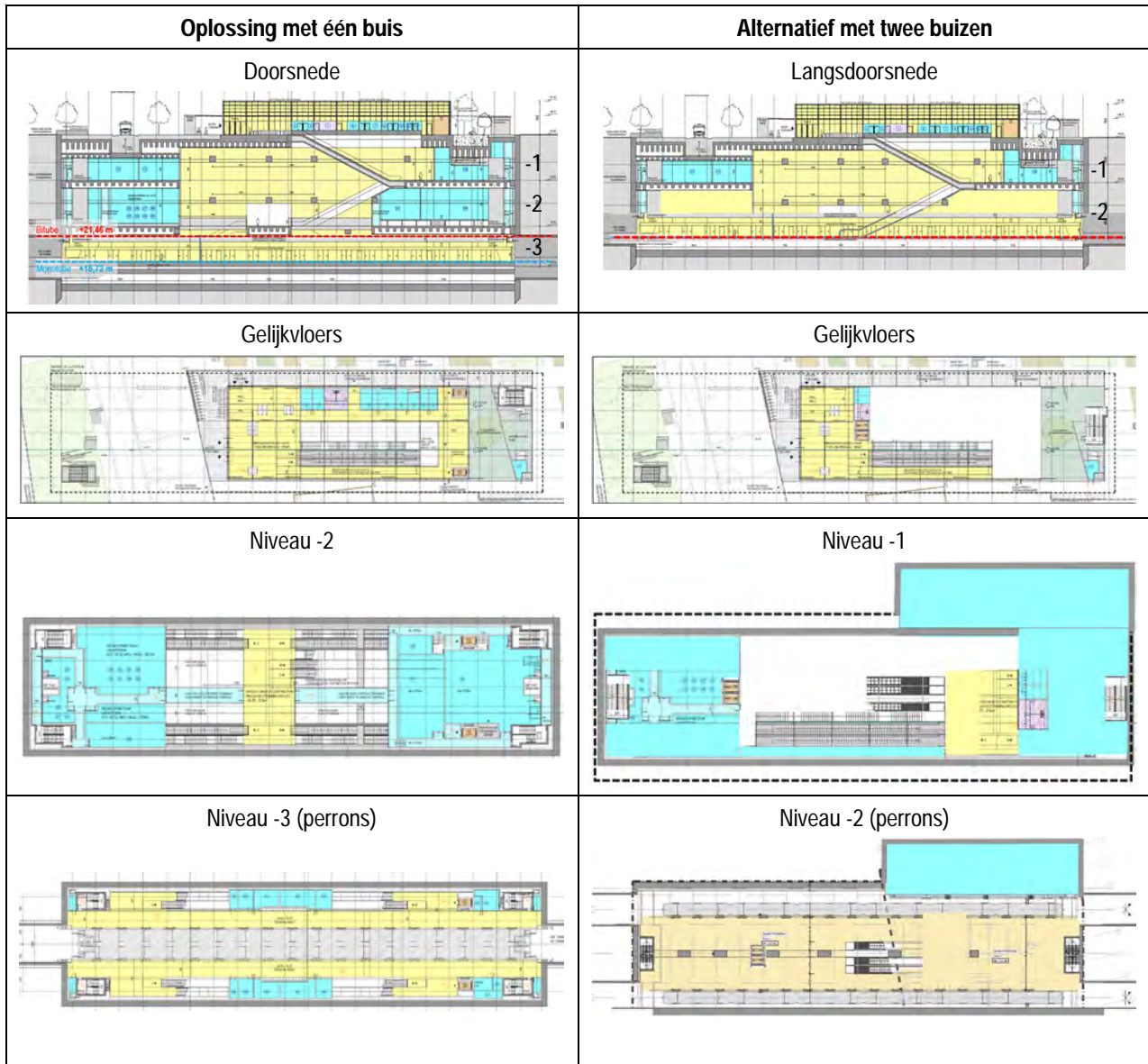
Figuur 78: Binnenverdeling van het station Linde: één buis (ingediende plannen) versus twee buizen (principeschema's) (BMN, 2017; ARIES, 2020)
