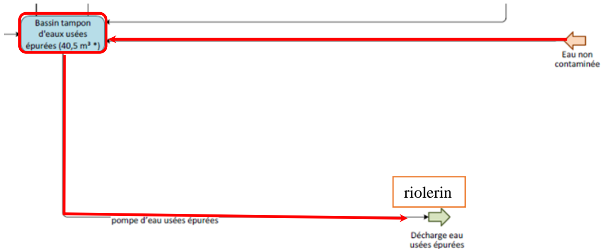
Figuur 3: het traject van het schoon water (schema ARIES op basis van het algemeen schema van het RWZI dat is bijgevoegd bij de Hydraulische Nota, BMN 2021)
