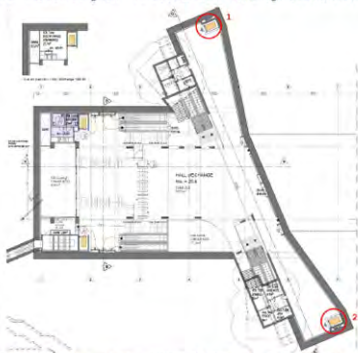
Figure 12 Station Colignon - niveau -1 (hall d'échange) - Affichage des ascenseurs pompiers
