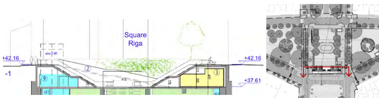
Figure 120 : Aménagement verdurisé prévu pour la face intérieure du mur bordant les escaliers (localisation de la coupe indiquée sur le plan) (BMN, 2018)
