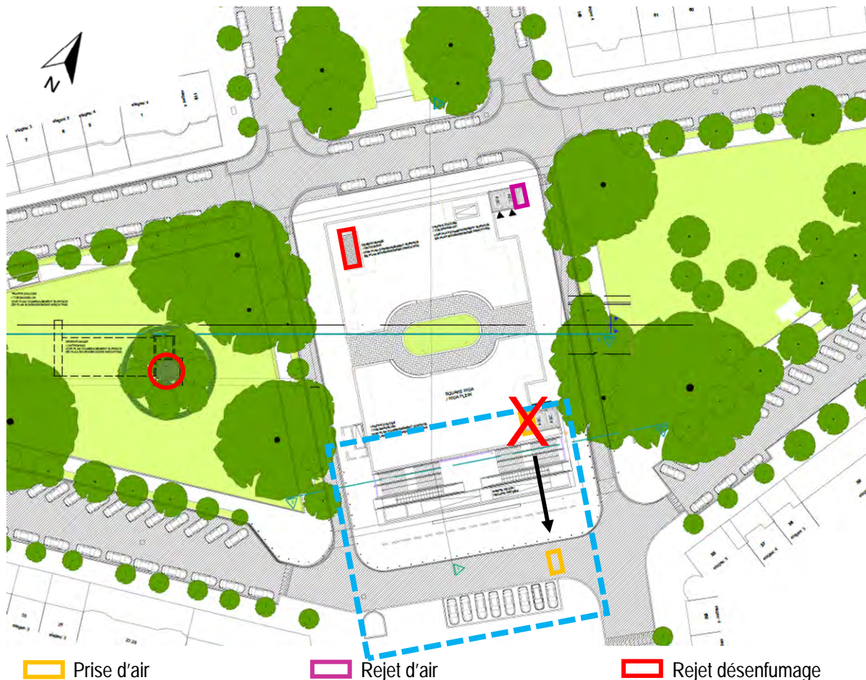
Figure 198 : Prise d'air à déplacer au niveau de l'alternative de localisation – Station Riga (ARIES, 2020 sur fond BMN, 2018)
