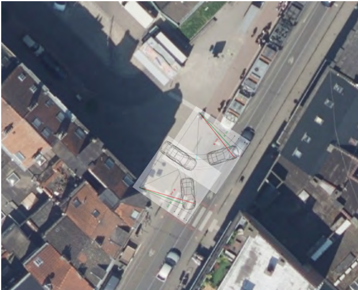
Figure 220 : Manœuvres en sortie de la voirie temporaire locale en phase de chantier sur la chaussée de Helmet (ARIES, 2021)
