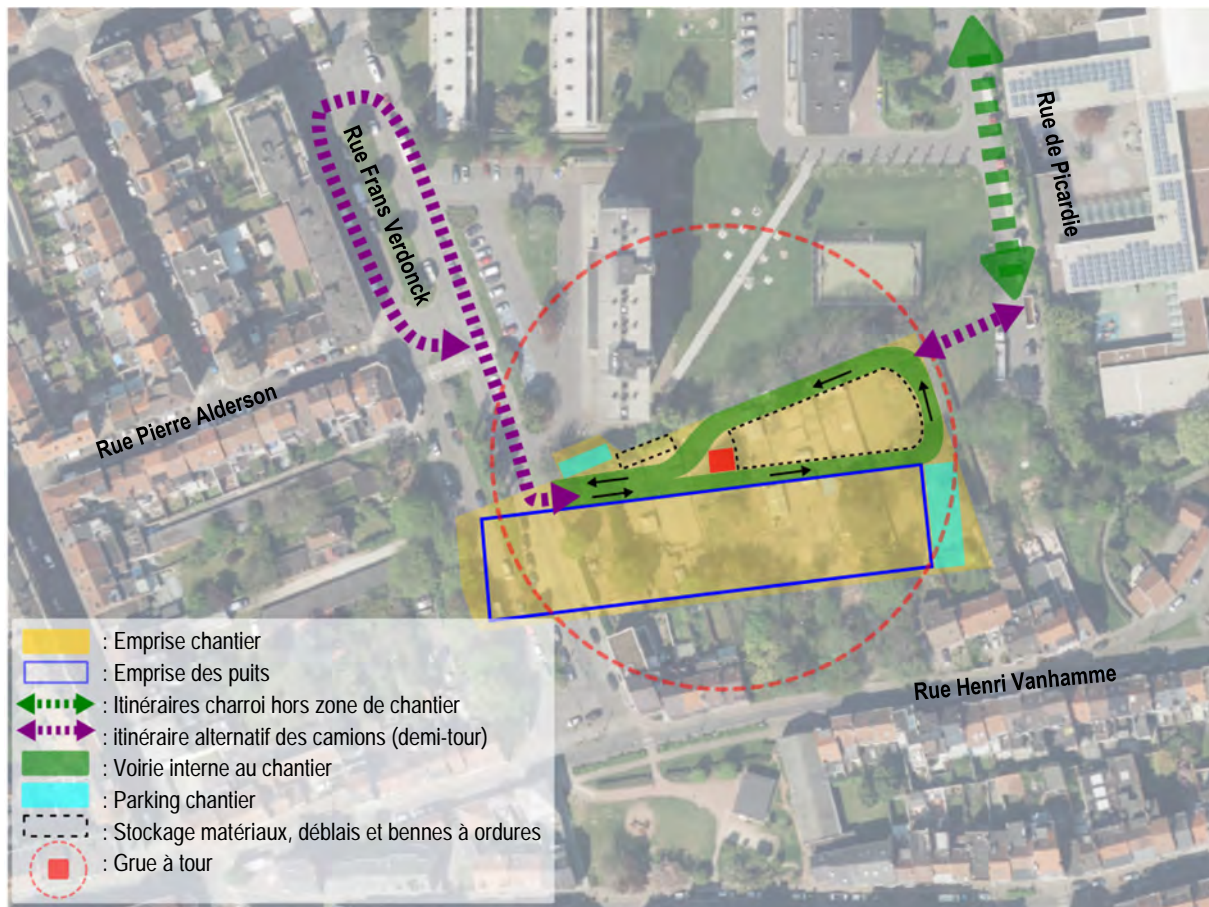
Figure 180 : Option B : Accès et d'itinéraire des camions alternatifs en cas de mise en cul-de-sac de la rue Frans Verdonck (ARIES, 2020)
