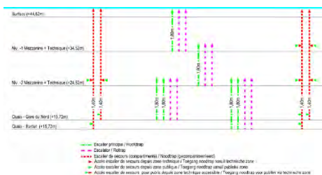
Figure 168 : Schéma d'évacuation de la station (BMN, 2018) Cette figure est reprise après le tableau en plus grand
