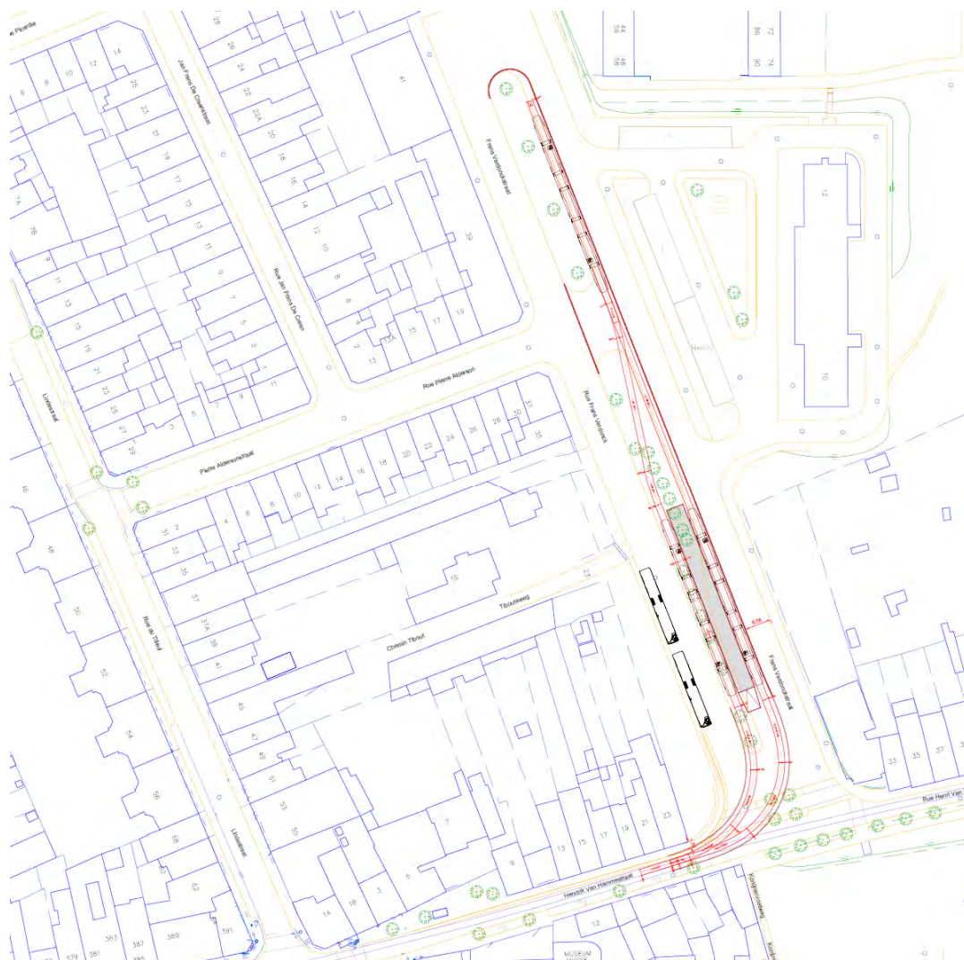
Figure 174 : Aménagement temporaire de la zone terminus sur la future station Tilleul avec zone d'embarquement « bus » (STIB, 2020)
