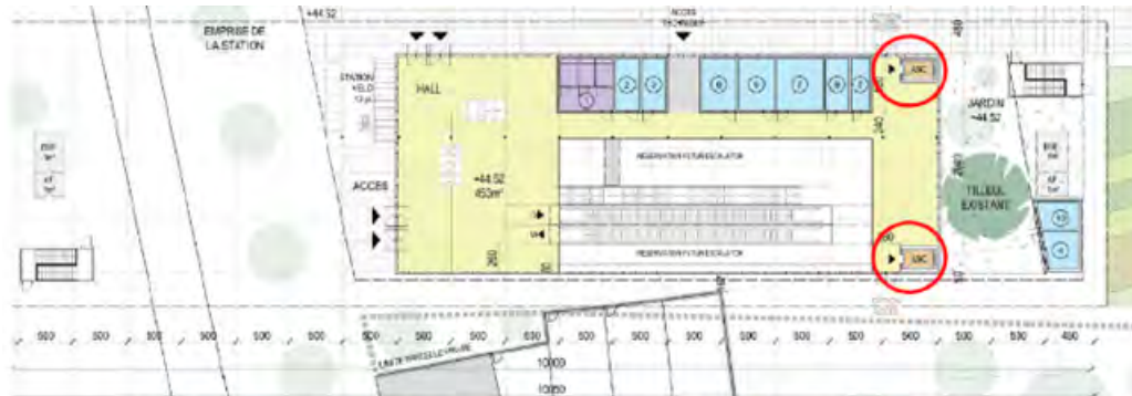
Figure 39 Station Tilleul – surface (hall d'échange) – Affichage des ascenseurs pompiers
