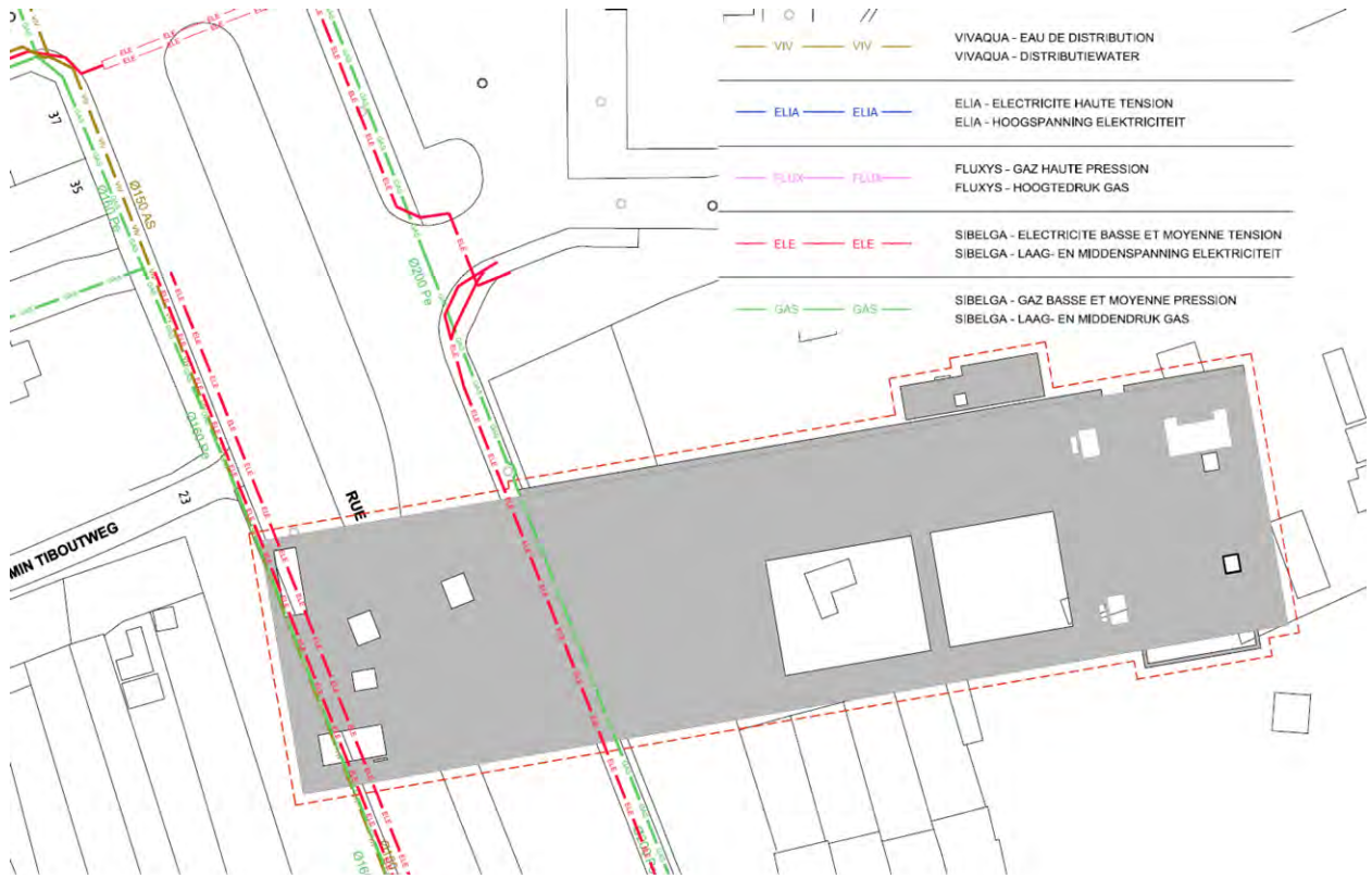
Figure 91 : Localisation des réseaux eau, gaz et électricité
