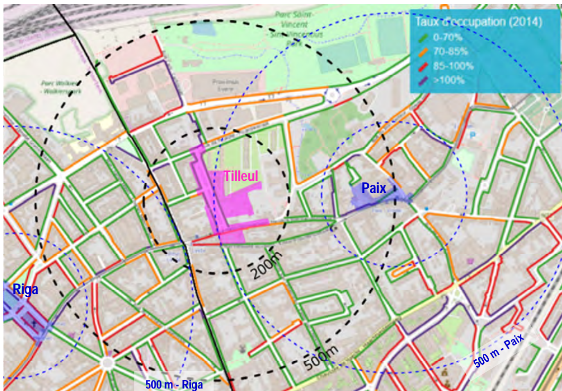
Figure 32 : Taux d'occupation diurne (10h-12h) des voiries dans l'aire d'étude 500 m (Parking Brussels, 2014)
