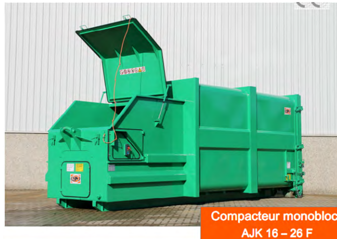
Figure 344 : Exemple du compacteur mobile récoltant les déchets ménagers du site (STIB, 2020)
