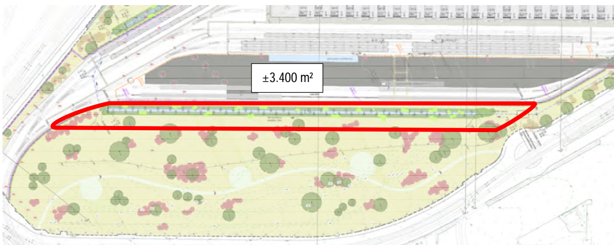
Figure 273 : Zone d'extension approximative des voies de remisage à l'horizon 2040 (ARIES sur fond BMN, 2018)
