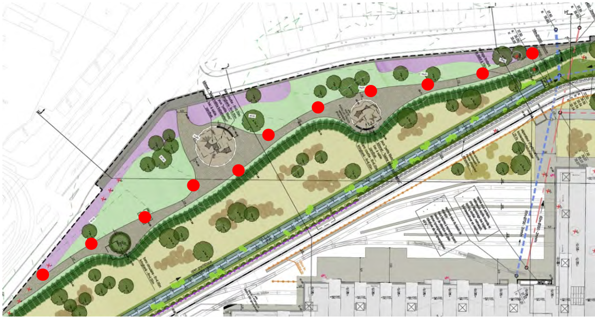
Figure 322 : Localisation des mâts d'éclairage (points rouges) au droit de la zone d'espace public créée (ARIES sur fond BMN, 2020)
