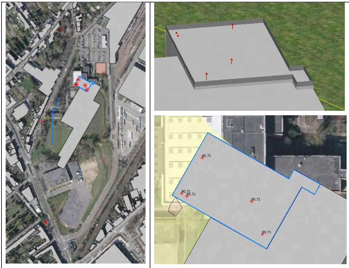
Figure 199 : Modèle acoustique de la situation future pour les installations sur le toit du bâtiment administratif – Sources de bruit en rouge (Tractebel, 2020)
