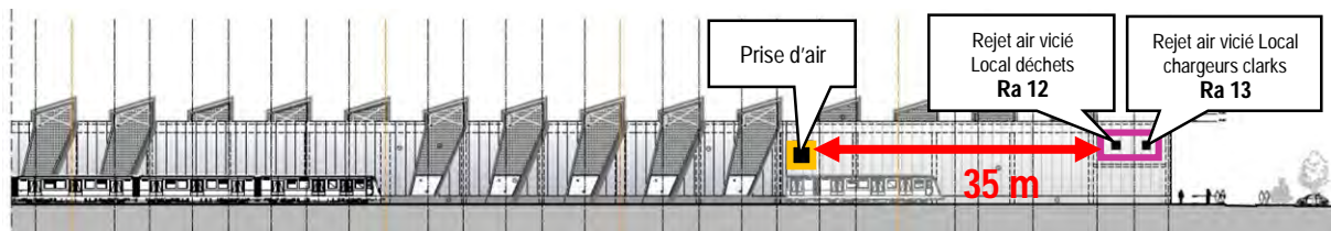
Figure 311 : Localisation des prises et rejets d'air – Façade est (partie nord) – Bâtiment atelier/remisage (ARIES, 2020 sur fond BMN, 2018)
