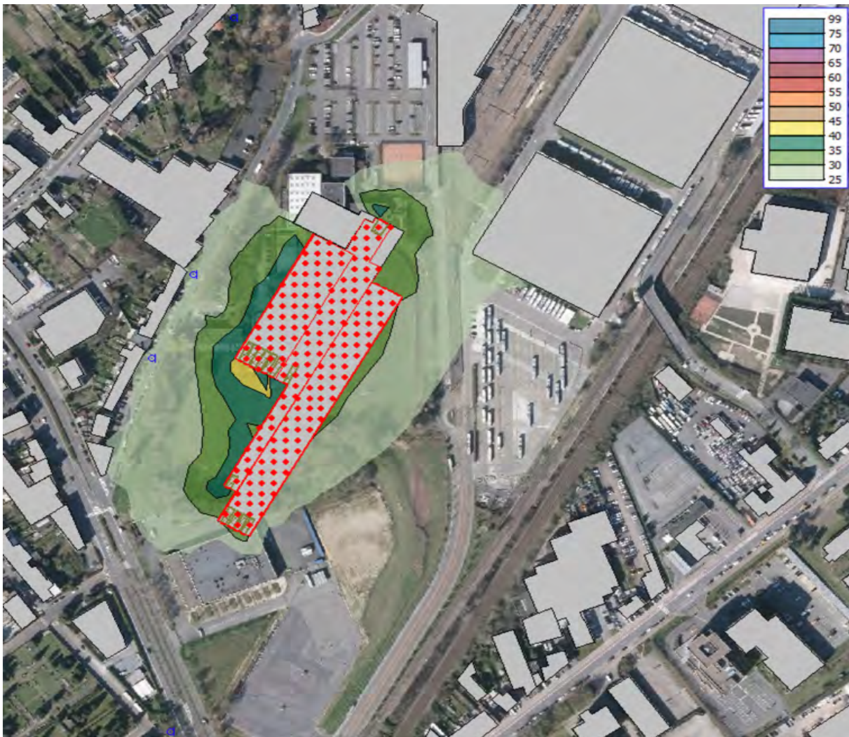
Figure 198 : Carte de bruit (LAEq) - Résultat de la modélisation pour le bruit émis par l'atelier. Les ronds bleus représentent les points de mesures de la situation existante utilisés dans la calibration du modèle ainsi que la rue du Biplan 128 où les incidences sont également calculées (Tractebel, 2020)
