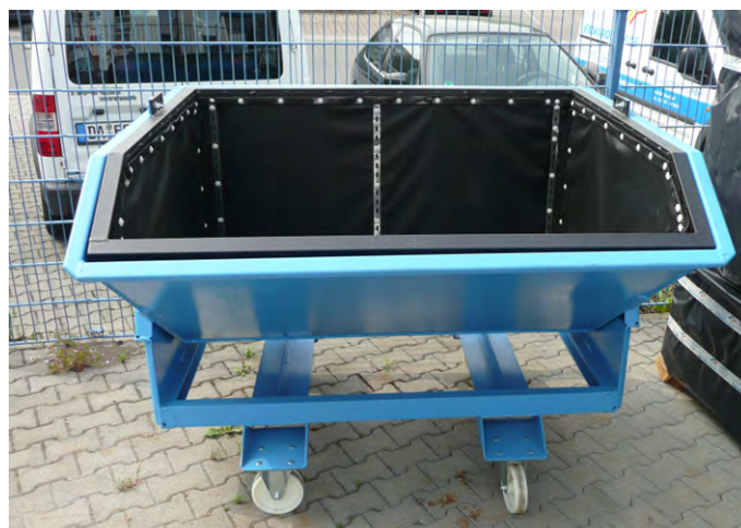
Figure 347 : Exemple du conteneur stockant le flotat issu du traitement des eaux de l'atelier et de la voie de dégraissage (STIB, 2020)
