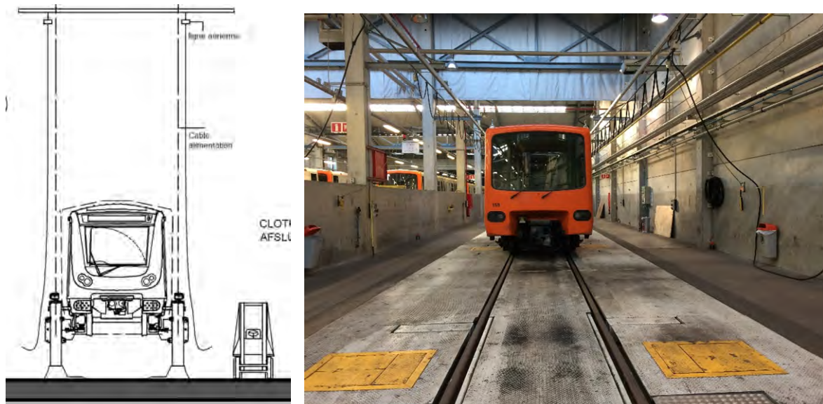
Figure 28 : Voie de levage - Coupe du projet (à gauche ; BMN, 2018) et photo au dépôt Jacques Brel (à droite ; ARIES, 2020)
