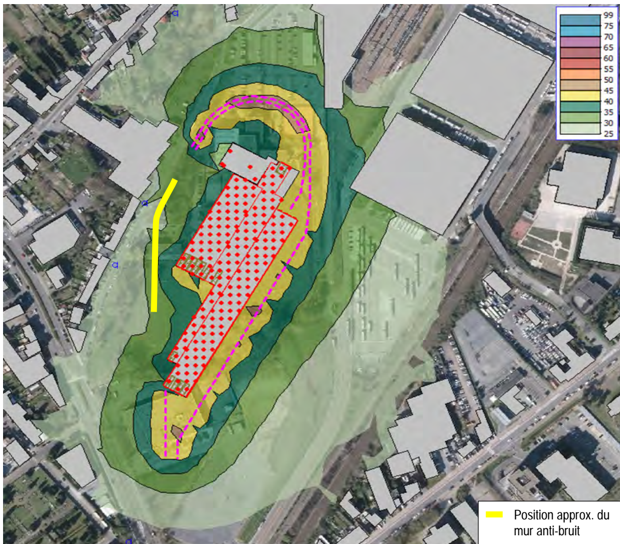
Figure 206 : Carte de bruit (LAeq,1h) résultat de la modélisation des bruits issus du projet avec la prise en compte de la mise en circulation de 6 métros (Tractebel, 2020)
